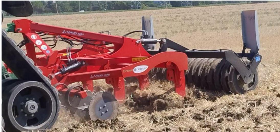
**1- Dissodatore (Green Breaker)** costituito da 7 ancore verticali disposte su 2 file con dischi frontali taglia residuo e rullo posteriore.
