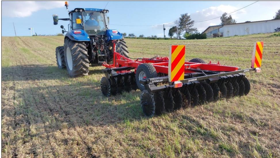
**3- Erpice a dischi (Vertical Tillage) trainato con telaio a “V”, con dischi turbo.**
