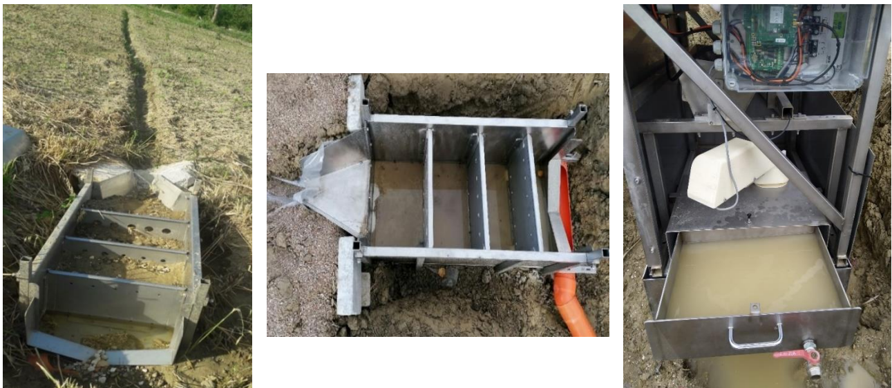
Fig. 5 Raccolta del materiale solido dalla camera dei vagli e della sospensione corrivata dal cassetto di raccolta.
