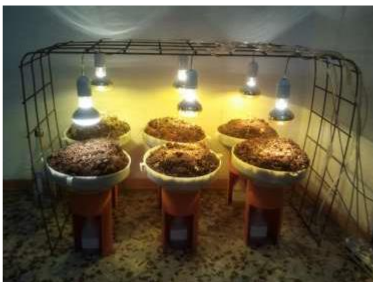
Figura 5. Selettore di Berlese-Tullgren per il prelievo della microfauna terricola
