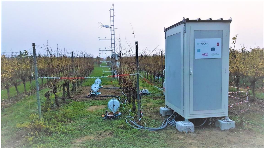
Figura 8. Immagine relativa alla strumentazione utilizzata per il monitoraggio in continuo dei flussi di GHG dal suolo vitato presso il sito di Bosco del Merlo. Le camere sono state installate nei pressi della stazione Eddy Covariance.
